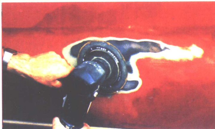
2. 对损伤部位进行打磨和打磨薄边
