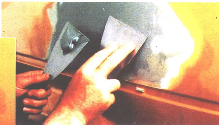
2. 打磨后涂上车身填料, 注意防止填料边缘与划痕外缘分离
