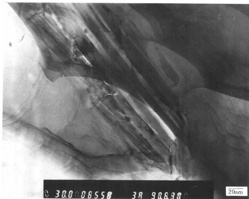
图 1-11 图 1-10 中片状石墨局部的形貌(TEM, 明场)
