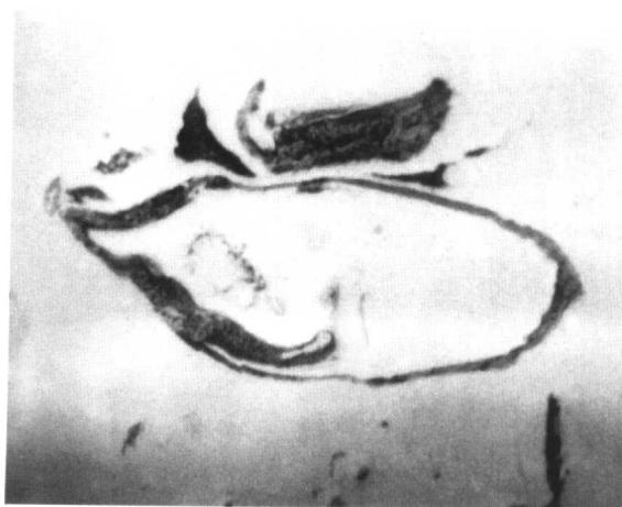
图 1-2 萃取出来的片状石墨重新镶置后的光学显微镜照片 400 ×
