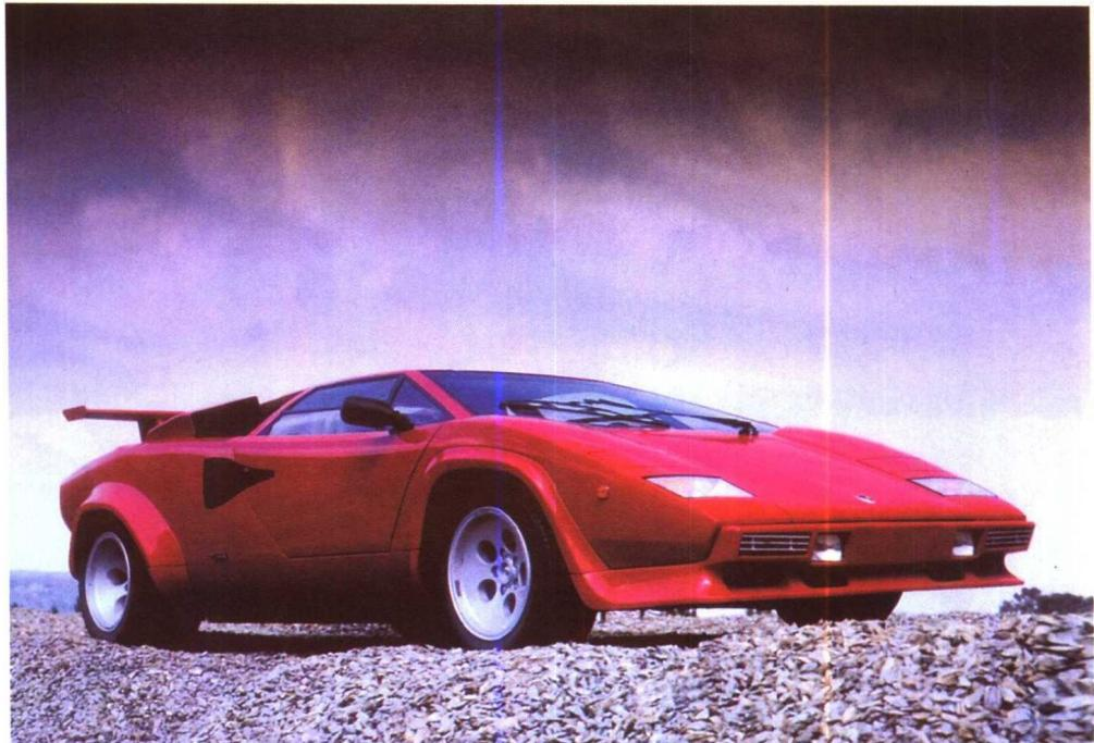
应该说，位于意大利的兰博基尼公司在90年代初已经停产了“康塔什”跑车。然而，关于“康塔什”的神话却一刻也没有停息。直到今天，人们提起超级跑车，仍然会以“康塔什”为例展开叙述。可以这样说，已生产的“康塔什”的所有产品都已成为汽车收藏家们的珍品。“康塔什”的所有棱角、线条和凹陷面都使其充满着迷人的曲线。车长4200毫米，宽2000毫米，高1070毫米，重1680千克。最高时速295千米/小时，0~100千米/小时加速需5秒。
