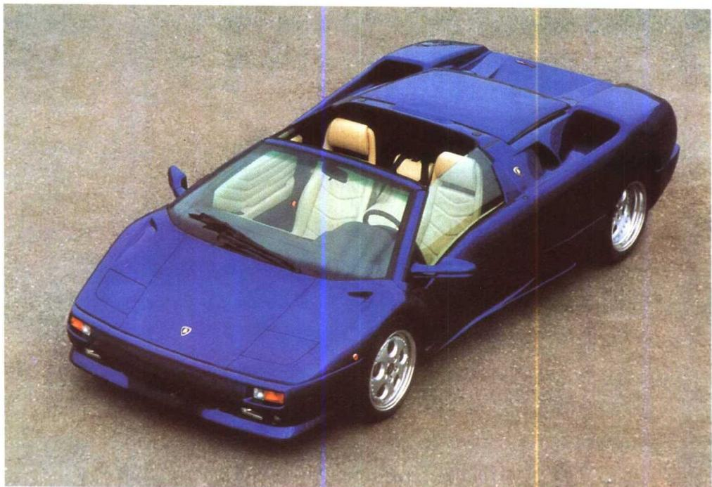
VT双座敞篷车是“迪亚波罗”车系中最新推出的车型。其车型可拆卸，固定在后机器盖上，是当今世界上屈指可数的一款敞篷车。该车长4470毫米，宽2040毫米，高1115毫米，重1625kg，排量5.7L。罩上车篷时最高时速325千米/小时，敞篷时最高时速305千米/小时，0~100千米/小时的加速仅需4秒。在“迪亚波罗”其他车型均采用后轮驱动的情况下，VT敞篷车系用全轮驱动，以处处呵护它的高速驾车者。
