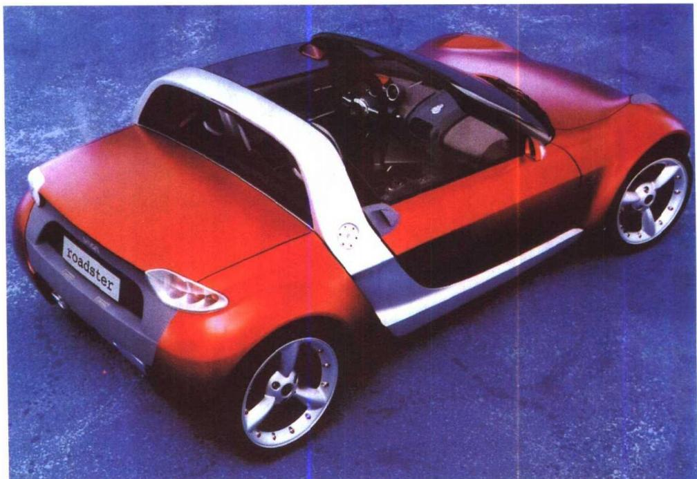
该车体现了戴姆勒——克莱斯勒公司的最新版“精简到极点”的设计思想，抓住驾驶乐趣这一重点，同时兼顾舒适性。这辆双座运动车的重量不过700千克左右，完善地处理了不同的性能要求之间的矛盾。满足了尺寸紧凑、空间宽敞和碰撞安全性等方面的要求。其总长仅3233毫米，宽1600毫米，车高1170毫米。该车的传动系、发动机的合理布置使得其重心非常低(离地455毫米)。保证了汽车操纵灵敏和有运动车的感觉。该车采用SUPERX型3缸涡轮增压发动机和6速传动箱。排量600毫升，最高车速没有被限制。
