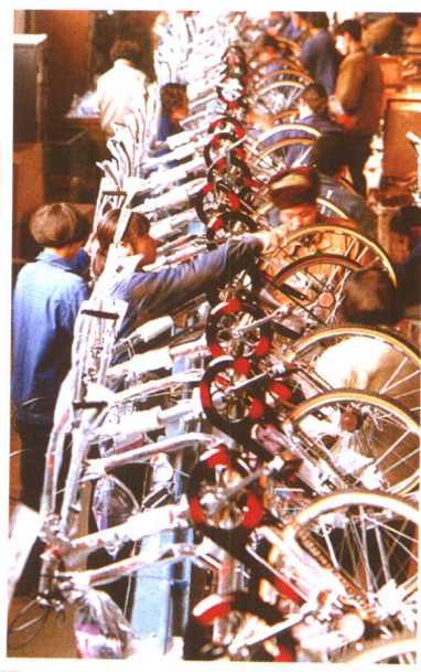
飞鹰公司自行车安装流水线
