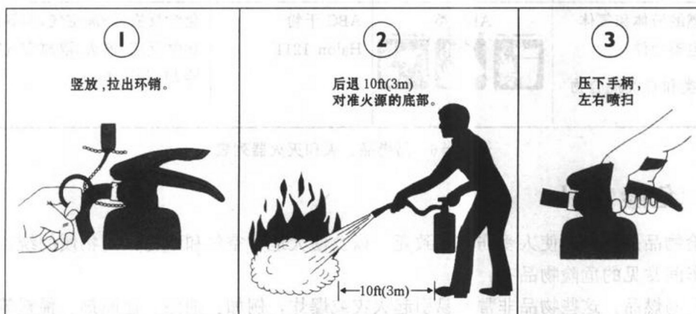
图 1-5 灭火器的使用方法
