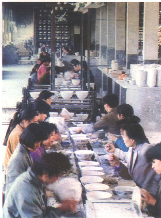
衡山瓷厂成型车间流水生产线 ▷
