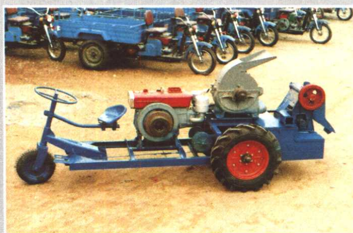
万宁县农机厂生产的 DSL—700 型多功能流动式碾米机
