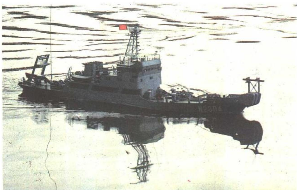
▲航海模型附图9 “N2304号”布缆 船模型，浙江李 胜巧制作。船首 有收放海底电缆 的大滑轮，船尾 有吊架和埋设犁。 全船呈蓝灰色， 这是军用舰船的 标志。
