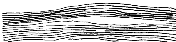
图1-5 纤维素纒状胶束结构图
