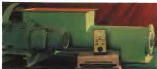
省飼料公司和上饒地區糧機廠合作研制的飼料粉碎機自動喂料器
