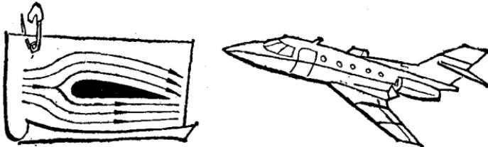
坦，从翅膀上面流过去的空气速度比较快，压在翅膀上的力量就比较小，从翅膀下面流过去的空气的速度比较慢，顶着翅膀的力量就比较大。于是，翅膀下面的空气就把飞机托起来了。
