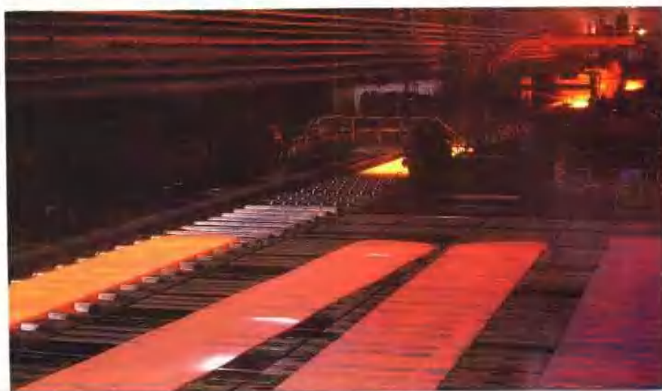
半连续轧板厂轧板生产线
