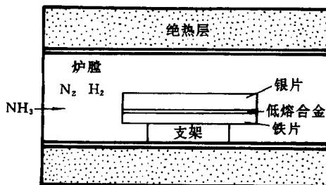
这个例子中，如果要讨论烧结工艺的有关问题就可把整个烧结炉作为系统，它包括金属片、低熔点合金和气体介质，而烧结炉外空间中的物质则均为环境。如果
