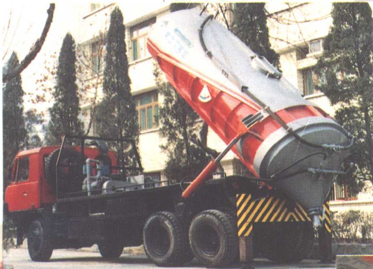
南充石油汽修厂组装的气动下灰车
