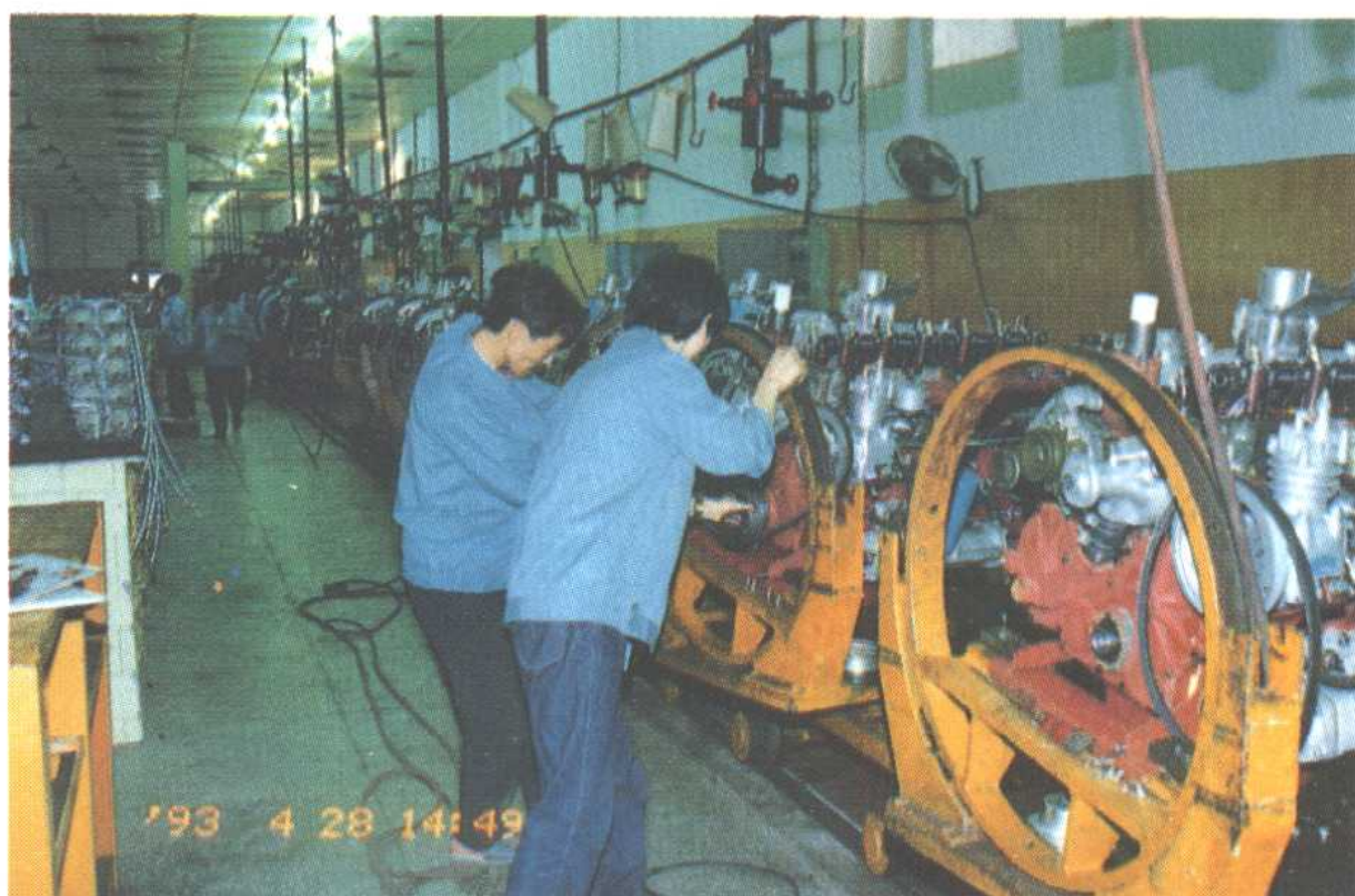
内燃机厂柴油机装试生产线
