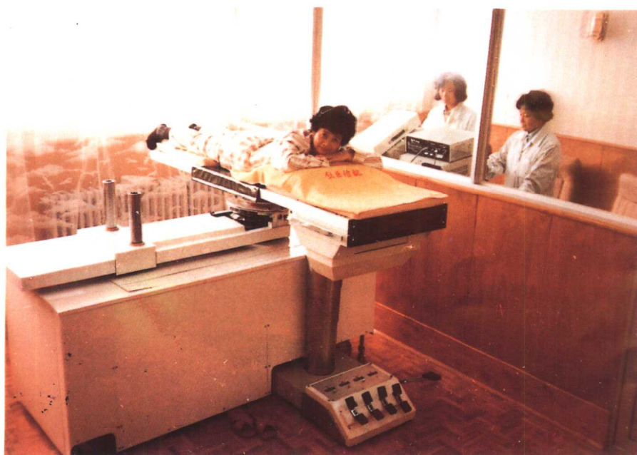
图5 中国第一台胆石体外冲击波碎石机——NE II型
