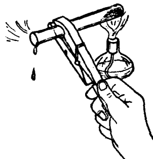
图 10 用试管加热潮湿的固体
