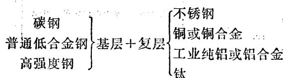
不锈钢/钢及铜/钢轧制复合钢板的品种与规格可参阅表 1-2。
