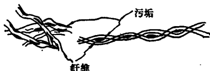
图2-1甲 污垢粘附在织物纤维上的示意图
