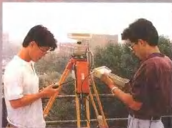
利用GPS卫星接收机进行大地测量
