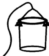
● 取透明塑料药瓶，在瓶口两侧离口边约5毫米处，分别钻孔。
