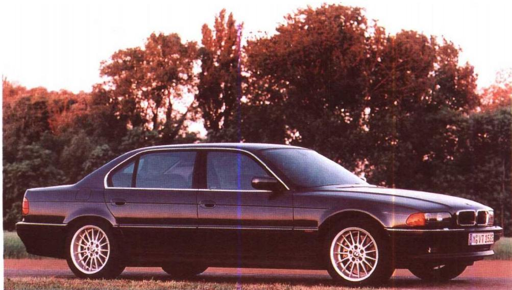
该车为宝马大型高档四门豪华轿车，为车轴距型。排量5.4升，100千米油耗14.2升，从0~100千米加速时间仅需6.6秒。全长5024毫米，全宽1845毫米，全高1400毫米。最高时速250千米。其高舒适性座椅具有电加热功能，靠背和头枕可以电动调节，还可以调整腰部支撑，前排座椅具备记忆功能。双层玻璃不仅减轻了车内噪声，还提高了空调系统的效率。该车还有高精度的预编程通风系统，并装备微波监控和侧倾报警等防盗设备。
