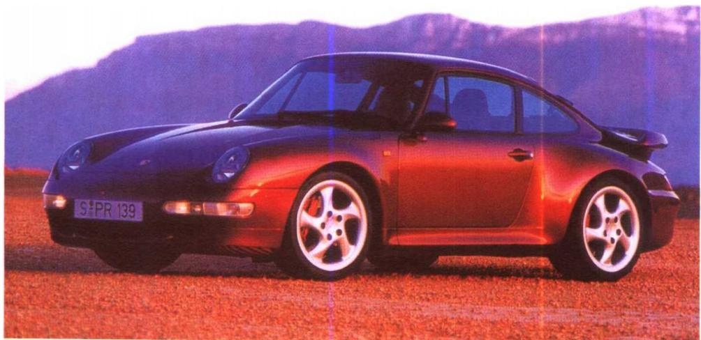
到1998年底，保时捷911Turbo轿车是保时捷911车系中最新型、也是动力最强劲、速度最快的一种车型。该车采用了许多最新技术。该款轿车的扰流板与其它使用可伸缩式扰流板的911不同，其鲸尾式的固定扰流板极富特色。该车全长4260毫米，全宽1795毫米，全高1315毫米，全重1500千克。最高时速290千米，从0~100千米的加速仅需4.5秒。911Turbo集保时捷三十多年技术精华于一身，跻身于超级跑车行列。
