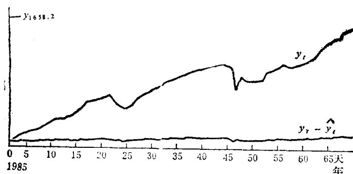
图 5 徐州台倾斜仪 EW 向 1985 年模型输出与残差曲线图
