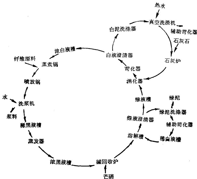
黑液有机物在燃烧时放出的热量，可以用于产生蒸汽供生产使用，碱回收炉炉尾还有 300℃ 左右的烟气也可用于直接蒸发浓缩黑液。
