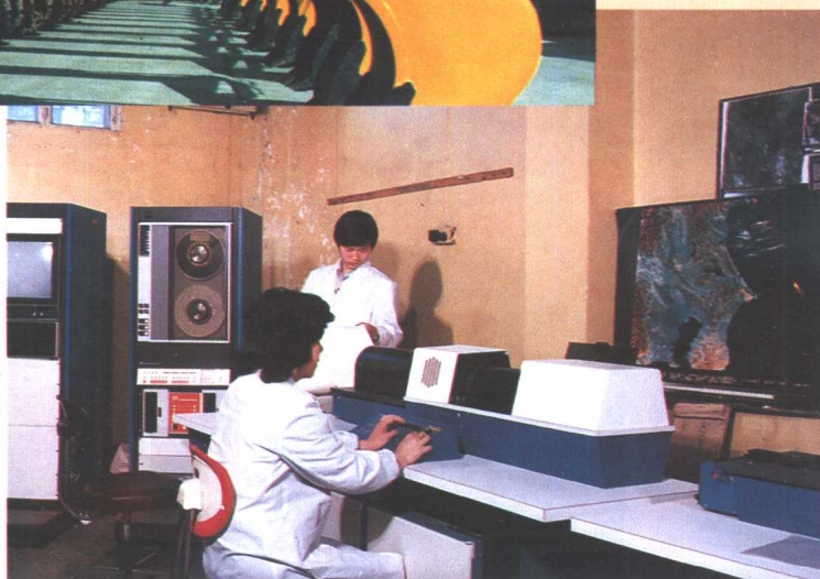
新天精密光学仪器公司从美国引进技术国产化后生产的C4500彩色影象扫描系统。 新天公司供稿
