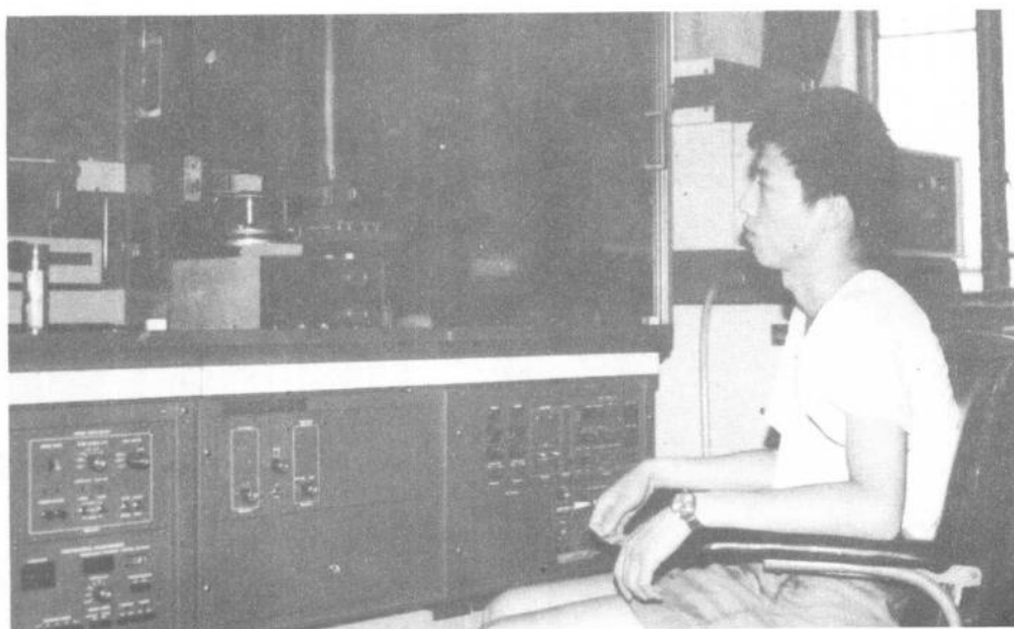
湖北省化学研究所是省科技体制改革试点单位之一。图为该所副所长李小定正在使用理学3015型X射线衍射仪测定新型催化剂的微观结构。
