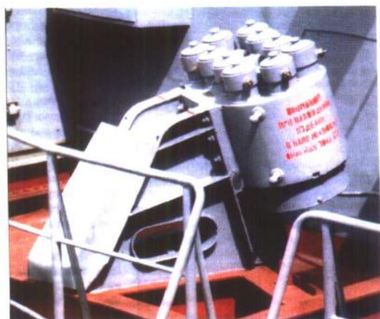
俄罗斯 PK-10 诱饵系统的 KT-216 固定式发射架
