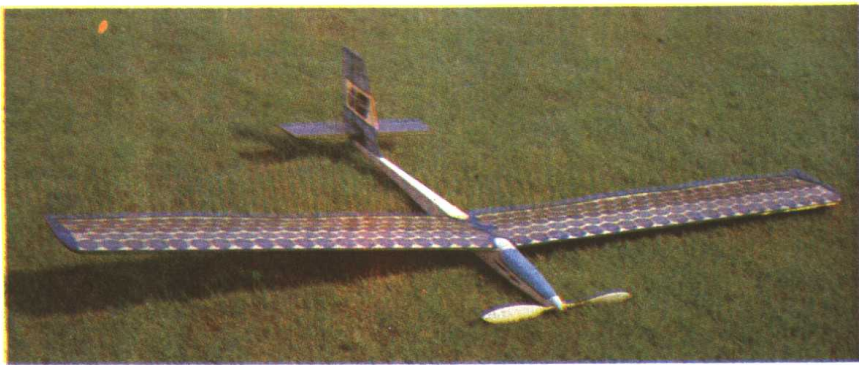
▲航空模型附图33 一架日本的太阳能遥控模型飞机
