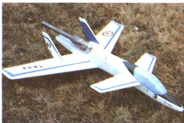
▲航空模型附图14 用喷气发动机的遥控模型飞机
