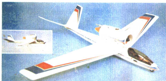
▲航空模型附图42 利用涵道风扇推进的模型飞机
