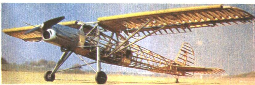
▲航空模型附图22 一架象真模型飞机的骨架
