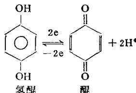
这个反应很快而且是可逆的，足以在电解池中产生重现性的电极电位。反应的平衡位置与氢离子浓度的平方成比例，在水溶液中改变一个 pH 单位，电极电位变化 0.059 伏特。所以可用这个反应来测定水溶液中的 pH 值。
