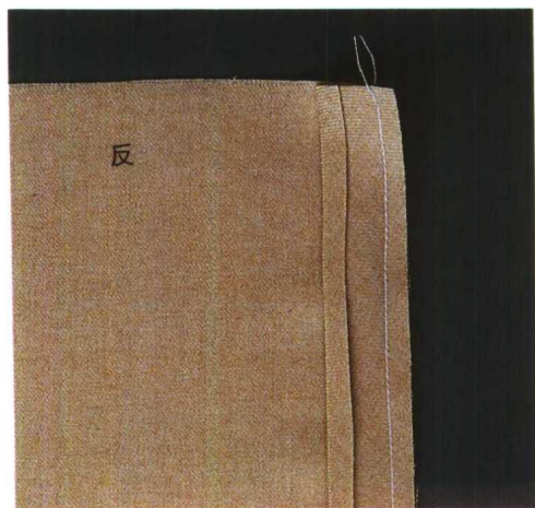
3 滚条正面与衣片反面相对叠合,平缝,缝份座倒烫。
