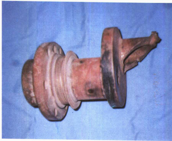
连杆轴颈扭转疲劳断裂（疲劳源在油孔处）
