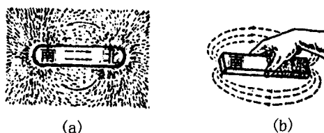
图 1-9 磁铁周围的磁力线
