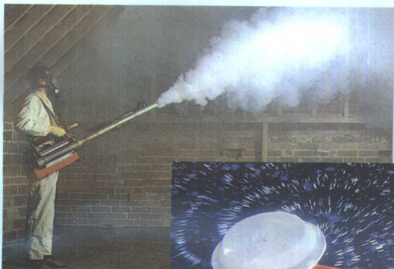
控滴雾机的雾化状况 (示雾滴的离心式分布)
