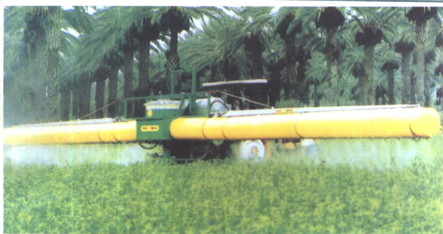
新型机载喷雾机—袖筒式喷杆喷雾机
