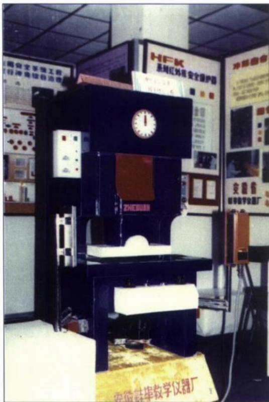
安徽蚌埠教学仪器厂生产的装配红外线安全 保护器的冲床（模型）
