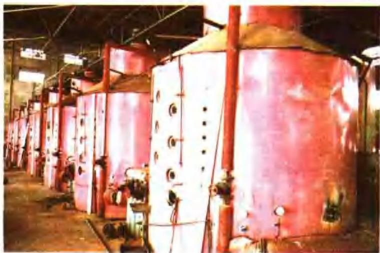
包头市轻工机械厂生产的 TQG30 强制循环结晶罐
