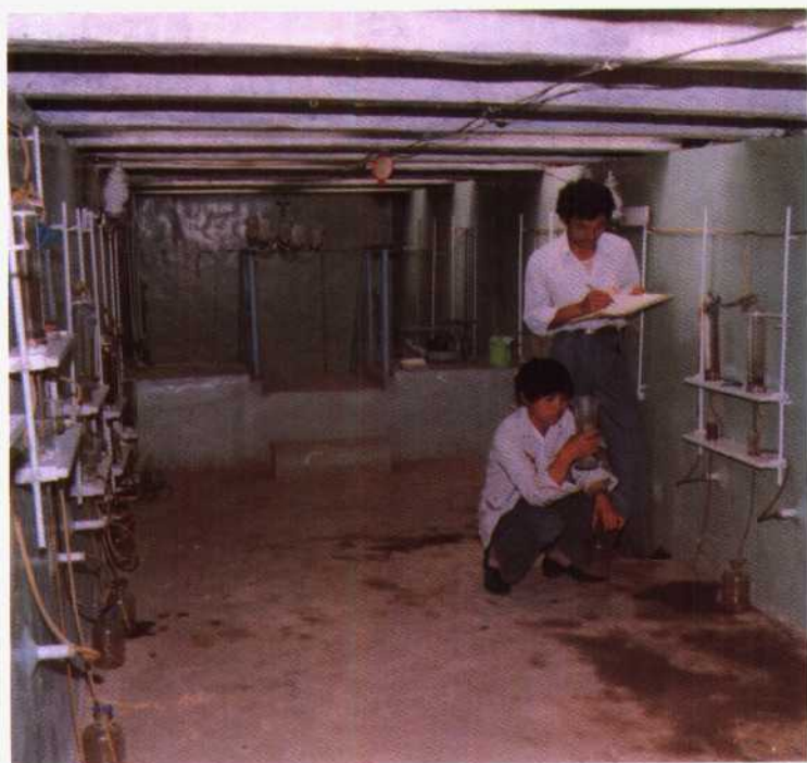
潜水蒸发试验地下观测室
