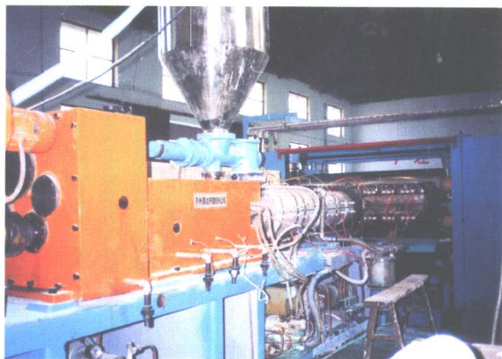
图6-9 双螺挤出机用衣架式机头直接挤出PVC软质卷材
