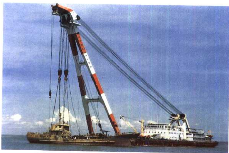
“南洋” 号打捞船进行整体打捞作业 （90 年代）
