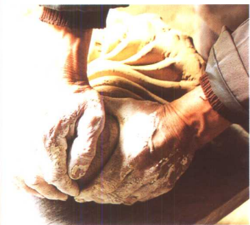
图2 按顺时针方向将泥旋转起来
