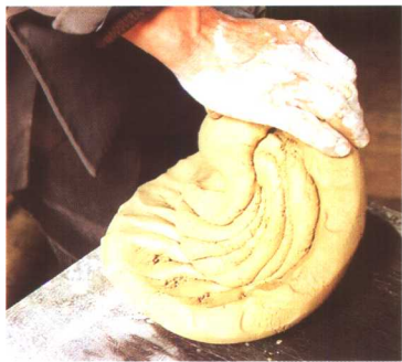
图3 以一个支点,有节奏、用力均匀地旋转泥
