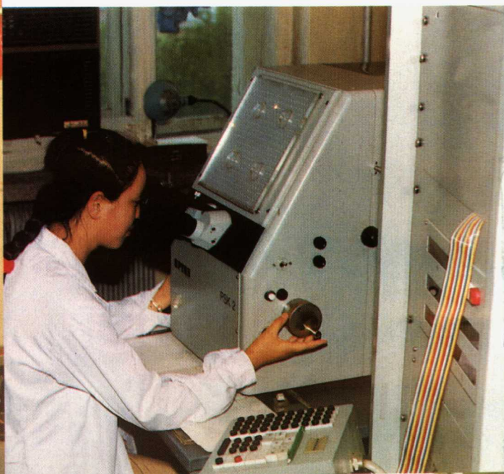
▼ 航测人员在立体坐标量测仪 PSK-2 上进行观测加密
