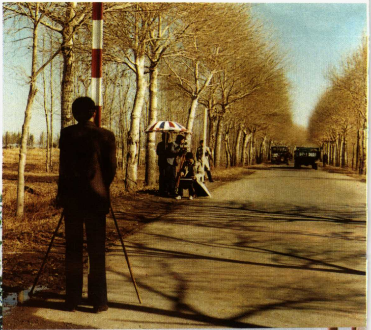
▼ 大地测量人员进行水准测量
