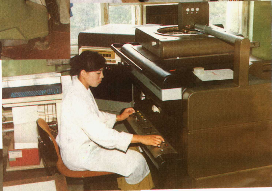
▲ 航测人员在正射投影仪器 OR-1 上测制影像地图
