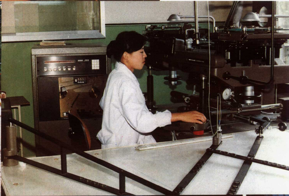
▼ 航测人员用AG1精密立体测图仪测图
