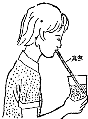
图1.3 玻璃管吸水形成真空
