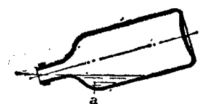
图 1-1-4 非匀质液体的最重部分滞留在瓶身往瓶颈突然过渡处
