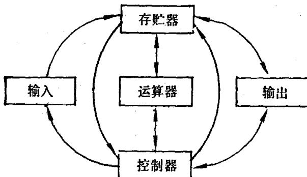
后在控制器的作用下，将指挥电脑各部份协调动作的命令，一条一条地从存贮器送到控制器，按程序规定的次序完成各种动作。例如，将数字从存贮器送到运算器，进行各种运算，将计算结果送回存贮器的某一个地方。最后，计算结果从存贮器通过有关电路送到输出设备，进行显示或打印。在这个过程中，电脑的输入输出设备起着眼睛、手、口、笔与纸的作用，而存贮器、控制器与运算器则起了大脑的作用。
