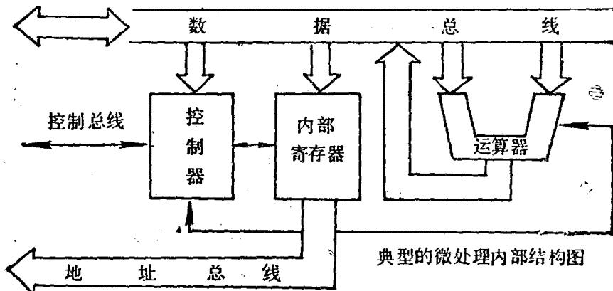
入端，通过数据总线相继接收两个数据，经计算后从输出端将结果回送到数据总线，由此再送入有关的寄存器。控制器通过数据总线从外部的存贮器接收指令，在它的控制下向微处理机内外各部件发出指挥信号与外界传送控制信号的这组线，称为控制总线，示于上图左方。数据总线、地址总线与控制总线组成微型电脑的系统总线。系统总线与微处理机的关系如右图所示。
