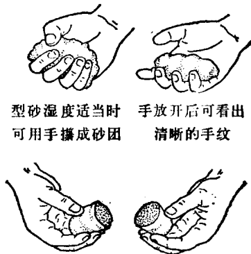
折断时断面没有碎裂状，同时有足够的强度
