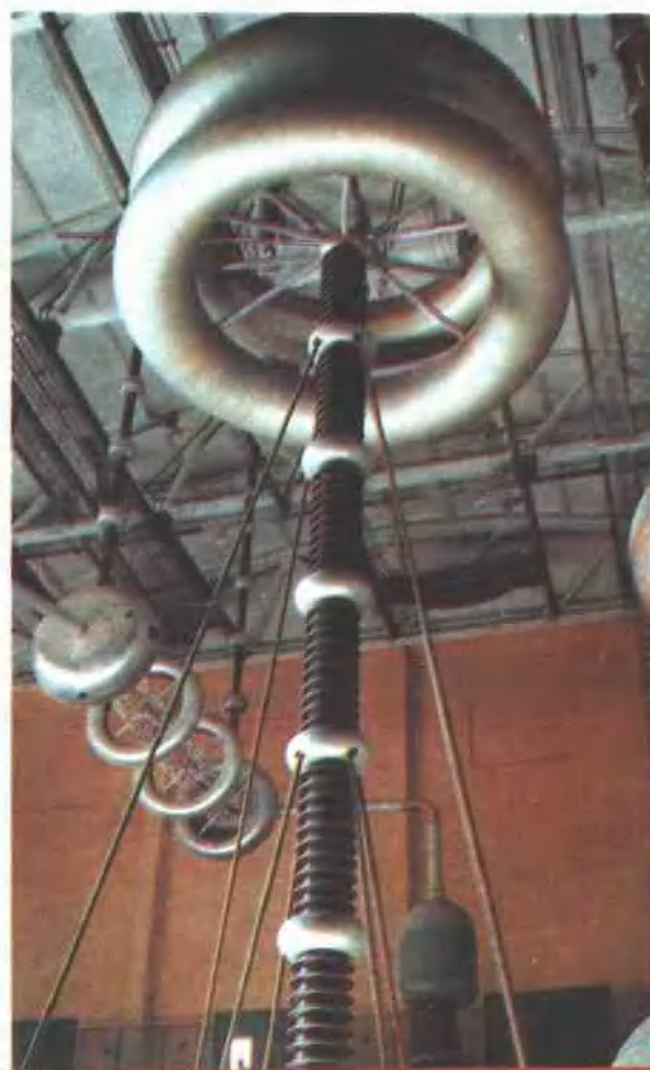
1000千伏工频电压试验装置
