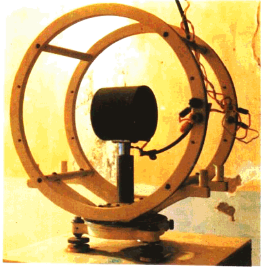
▲ 大连地震台磊子山核子旋进磁力仪
