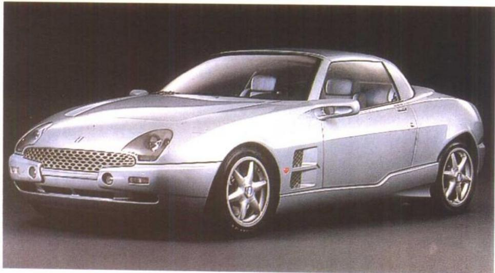
1996年，为摆脱产量低的困境，意大利托马索汽车公司推出了最新研制的“必佳”跑车，该车拥有前置双气门V8发动机，功率305马力，后轮驱动，最为独特的是车身采用可变化的合成材料，在取下车顶中部后，其可瞬间变成与保时捷“达佳”相仿的车型。此外，该车宽大的车顶后支架与后车窗可一起降下放在后座上。
