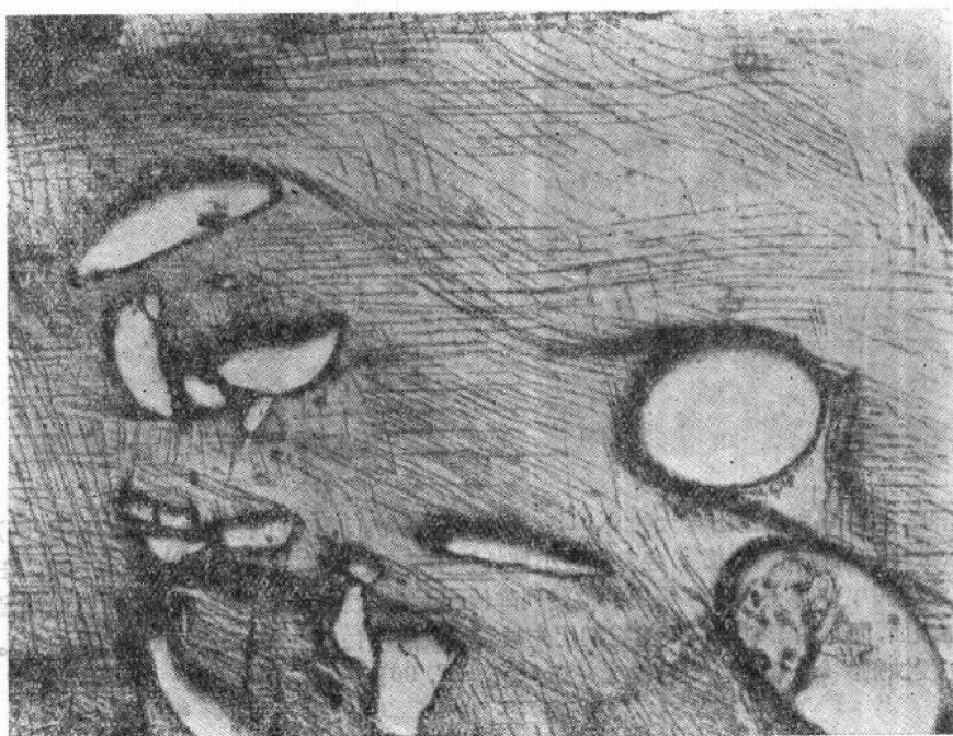
图 1-8 这幅显微组织图是在整个铜基体中弥散分布着短铅纤维的复合物中测定塑性应变分布的实验结果。试样加工成可在非轴向拉应力下作少量延伸。试样标距的表面按金相质量标准抛光。不需要浸蚀就能分辨组织中两个组成物，滑移带的浮凸花样表示复合物中塑性分布的情况，可看出铅纤维没有受到形变，这可由其中不存在滑移线来判断，滑移完全限于铜基体中。显微照片显示了滑移线的平行性和周期性、交叉滑移线以及形变带。由于没有涉及到位向变化，所以在重新抛光和浸蚀时，一般的滑移线花样会消失。然而，也可以看到已使某些滑移线族产生弯曲的浓密的交叉滑移区域，这意味着必然发生位向变化，在重新抛光和浸蚀时这些位向变化会继续存在。
