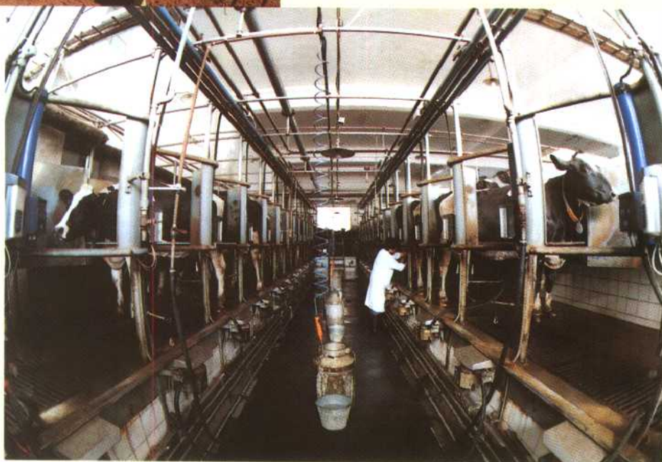
⇒ 奶牛中心良种场 鱼骨式集约化机械挤 奶设备。
