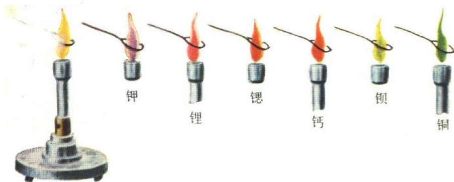
图 3 — 2 焰色试验可用来鉴定纯金属或金属化合物中的金属离子。
