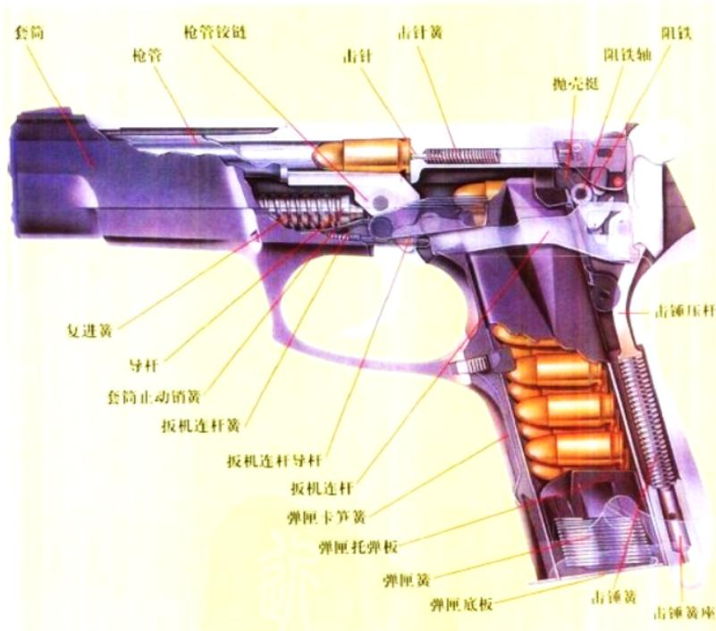
该枪是美国鲁格公司 20 世纪 80 年代末研制的新一代 9 毫米自动手枪。其外形美观，尺寸小，重量轻，结构简单，动作可靠，易于分解结合，射击精度好，后坐感轻。该枪全长 198 毫米，枪管长 114.3 毫米，重 934.4 克(带空弹匣)/1124.9 克(带实弹匣)，弹容 15 发。
